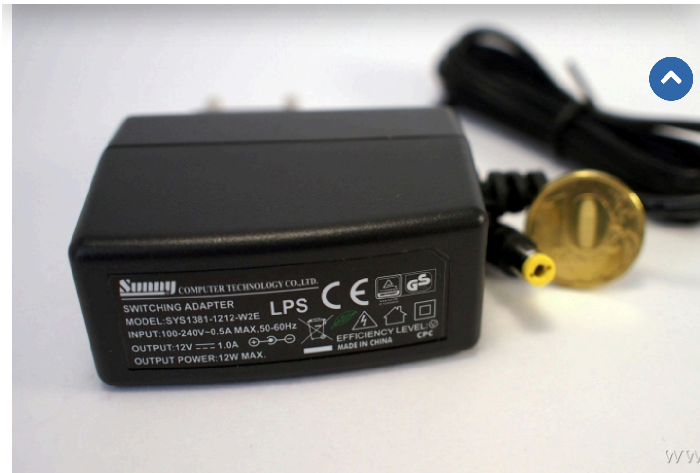
Рис. 5. Блок питания контроллера домашней автоматизации VeraEdge
